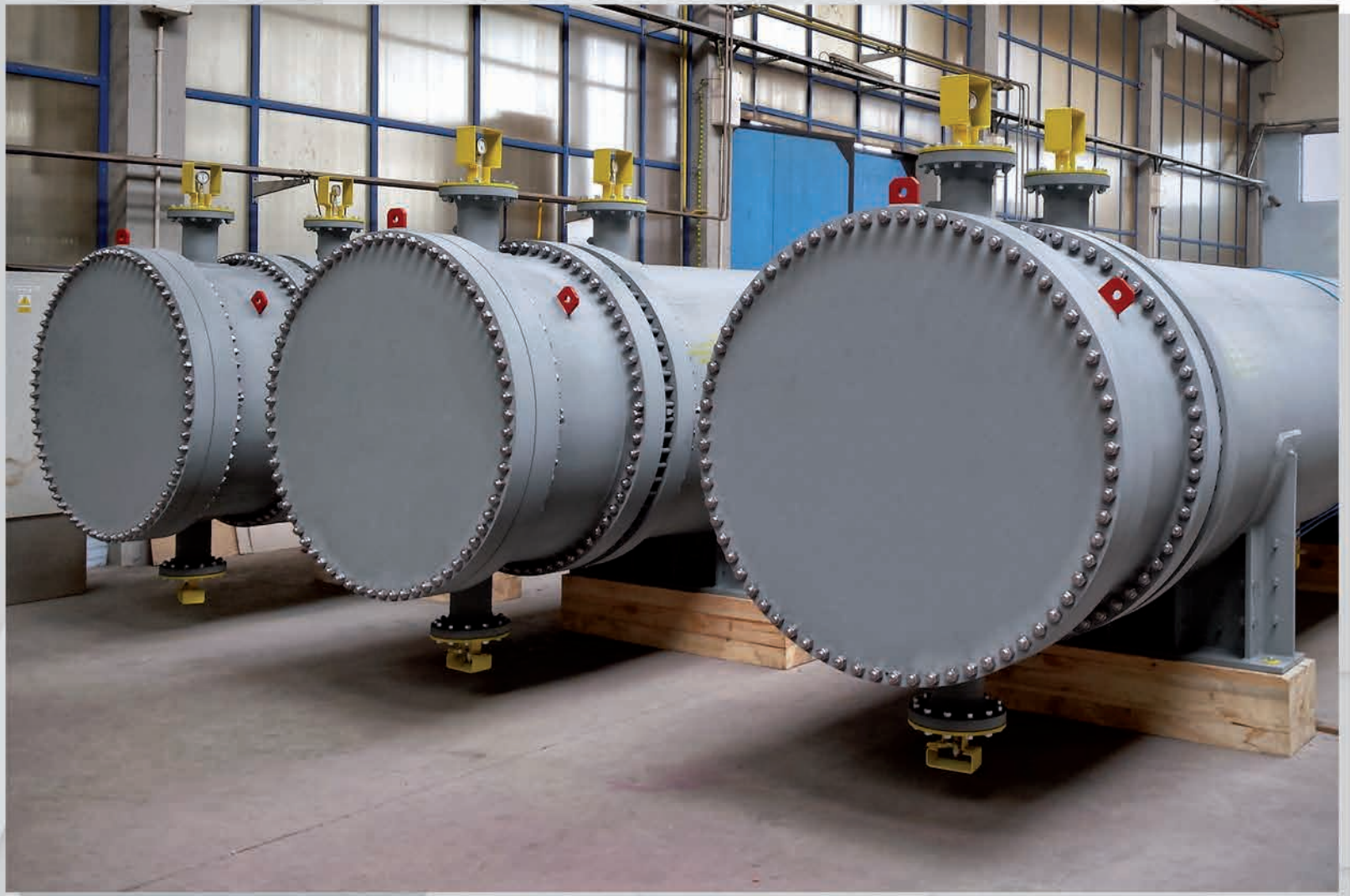
Wärmetauscher Typ AES – Ausführung gemäß ASME mit U-Stempel
